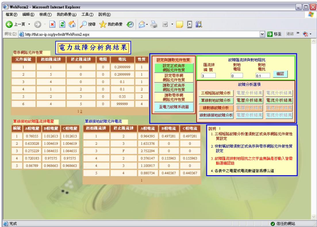
圖 15 5 個匯流排電力系統的電力故障分析結果
