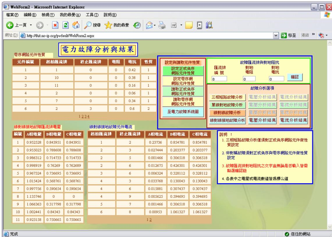
圖 17 11 個匯流排電力系統的電力故障分析結果
